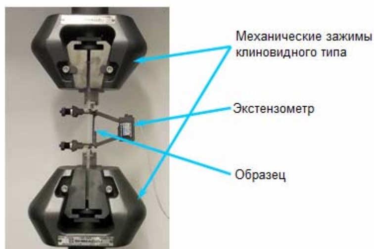
Рис.2. Закрепленный образец с экстензометром
